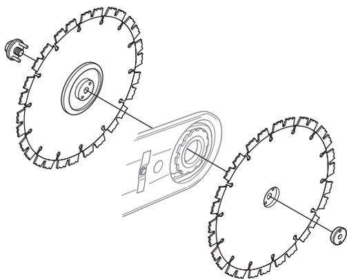
Диски должны вращаться при затянутой гайке. Это будет свидетельствовать о том, что ремень не зажат на дисках между объединенными половинами приводного ремня, когда диски и приводной ремень стягиваются с помощью гайки. Лучше это делать поочередно, то есть слегка затянуть, немного провернуть и так повторять, пока диски не будут закреплены.
