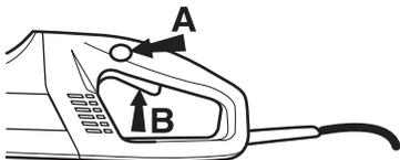
Фиксатор выключателя остается прижатым пока выключатель находится в нажатом положении. Когда захват ручки освобождается, то и
