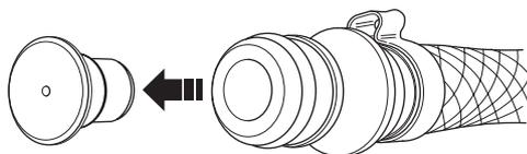
При низком давлении воды, например при использовании бака с водой, этот ограничитель может быть демонтирован, чтобы система получала необходимое количество воды.
